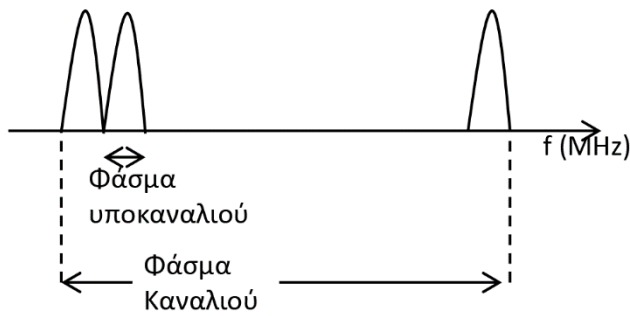
Εικόνα 7.11 Ισχύς φάσματος καναλιού OFDM.
