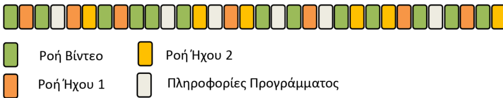
Εικόνα 5.6 Αλληλουχία πακέτων TS στην περίπτωση ροής μεταφοράς η οποία περιλαμβάνει ένα πρόγραμμα.
