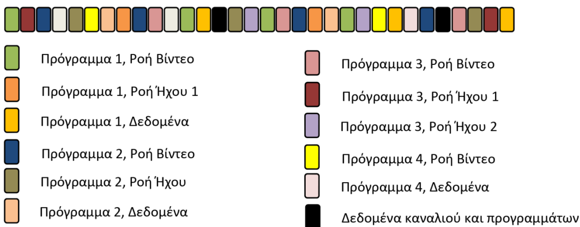
Εικόνα 5.7 Αλληλουχία πακέτων TS στην περίπτωση ροής μεταφοράς η οποία περιλαμβάνει τέσσερα προγράμματα.
