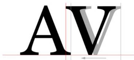
Εικόνα 8.29. Η ρύθμιση kern μπορεί να έχει και αρνητικές τιμές. Εδώ, παρά το ότι οι ιδεατοί χώροι που περικλείουν τους δύο χαρακτήρες επικαλύπτονται, η παρουσίαση των γραμμάτων φαίνεται φυσιολογική.
