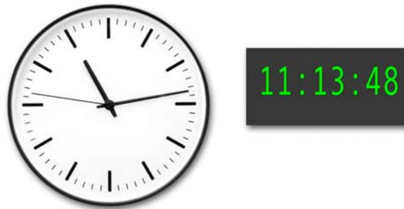
Εικόνα 1.1. Μια αναλογική συσκευή (αριστερά) και μια ψηφιακή. Και οι δύο συσκευές μετράνε χρόνο με ακρίβεια δευτερολέπτου. Η ακρίβεια της μέτρησης με το αναλογικό ρολόι είναι στην πραγματικότητα μεγαλύτερη από αυτή του ψηφιακού, καθώς η θέση του δευτερολεπτοδείκτη (αν θεωρήσουμε ότι κινείται αδιάκοπα) ανάμεσα σε δύο γραμμές μπορεί να είναι οπουδήποτε ανάμεσα σε δύο θέσεις (τιμές) πάντοτε υπάρχει μια ενδιάμεση. Στην καθημερινή
