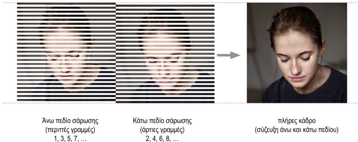
Εικόνα 7.2. Απλοποιημένη αναπαράσταση των δύο πεδίων διαπλεκόμενης σάρωσης. Οι λευκές γραμμές στα δύο πεδία αντιπροσωπεύουν μη πληροφορία και κανονικά είναι μαύρες, όχι με την έννοια του μαύρου χρώματος αλλά της μη ύπαρξης φωτεινής πληροφορίας.
