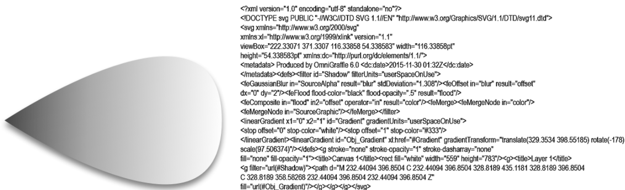
Εικόνα 3.12 Διανυσματικό γραφικό και ο κώδικας που το περιγράφει στη γλώσσα SVG (Scalable Vector Graphics). Τα διανυσματικά γραφικά είναι κειμενικές αναπαραστάσεις. Για την απεικόνισή τους σε φυσικά μέσα (οθόνη, εκτύπωση) θα πρέπει πρώτα να μετατραπούν σε ψηφιογραφικές εικόνες.
