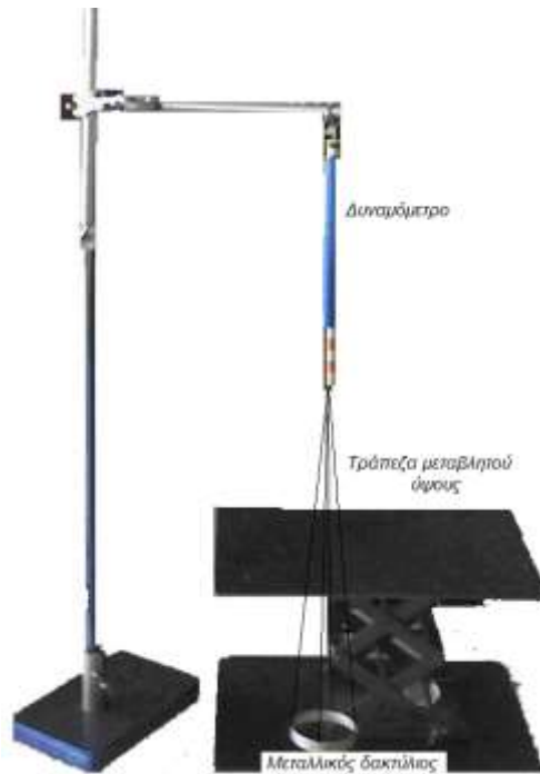
Σχήμα 13: Πειραματική διάταξη για την εργαστηριακή μέτρηση επιφανειακής τάσης υγρού.
