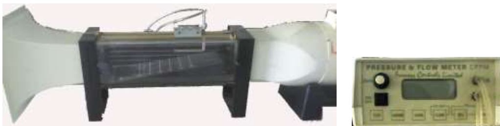
Σχήμα 17: Η αεροτουρμπίνα, η αεροσήραγγα και το ηλεκτρονικό μανόμετρο της πειραματικής διάταξης.
