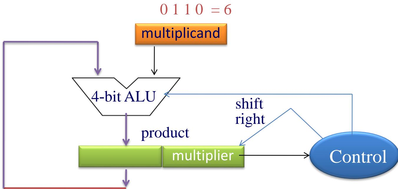
$$\begin{array}{r} 0000 \\ \text{add } 0110 \\ 0011 \xrightarrow{\quad} 0010 \\ \text{add } 0011 \\ 0001 \xrightarrow{\quad} 1001 \\ \text{add } 0111 \\ 0011 \xrightarrow{\quad} 1100 \\ \text{add } 0011 \\ 0001 \xrightarrow{\quad} 1110 \end{array} = 30$$
